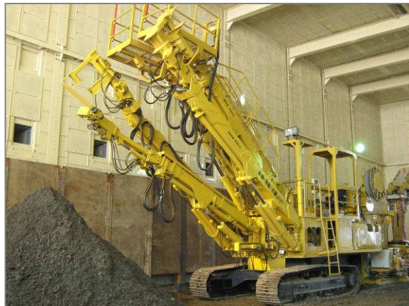
エレクター付き吹き付けロボット
