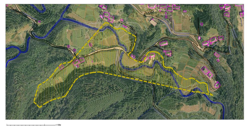
自然現象 の種類 様式-2(土) 土砂災害防止法施行令第二条の基準に該当する区域 土石流 渓流番号 362- Ⅱ -009-1 土石流の高さが1m超える場合、土石等の |土砂災害警戒区域・土砂災害特別警戒区域 移動による力が50kN/㎡を超える区域 土砂災害防止 法施行令第三 条の基準に該 当する区域 告示番号 茨城県告示89号 渓流名 館沢 土石流の高さが1m超える場合、土石等の 区域図(その1) 縮尺 移動による力が50kN/㎡以下の区域 1:2, 500 告示年月日 平成28年1月21日 所在地 茨城県常陸太田市天下野町 それ以外の区域
