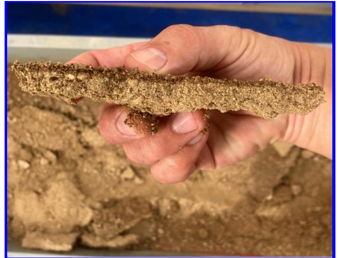
HR散布後の固化層
