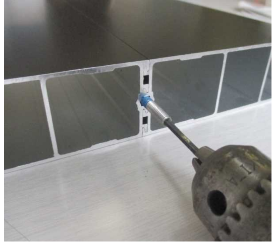
アルミ嵌合式両面表示標識板 ゆるみ止めネジ締付け
