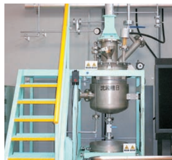
臨界事故を起こした沈殿槽(複製)
