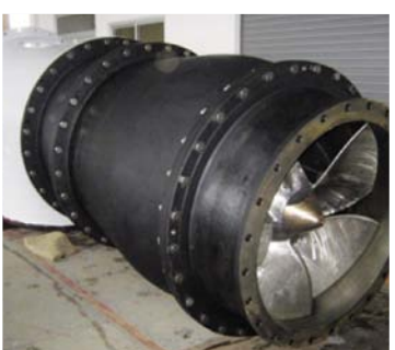
補修により機能回復した排水ポンプ
