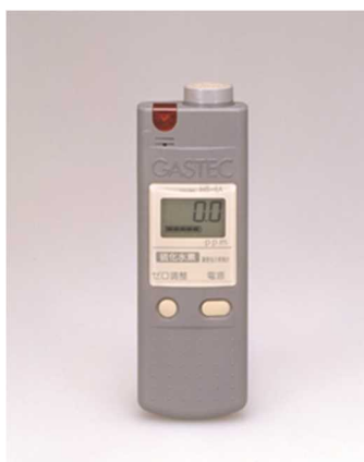
図 11 拡散式硫化水素計
