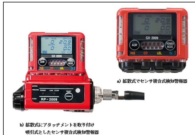
図 23 複合式センサ警報器でアタッチメントにより吸引式になるタイプ
