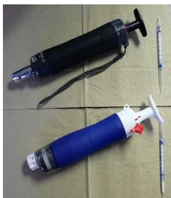
図 10 検知管法ガス採取器
