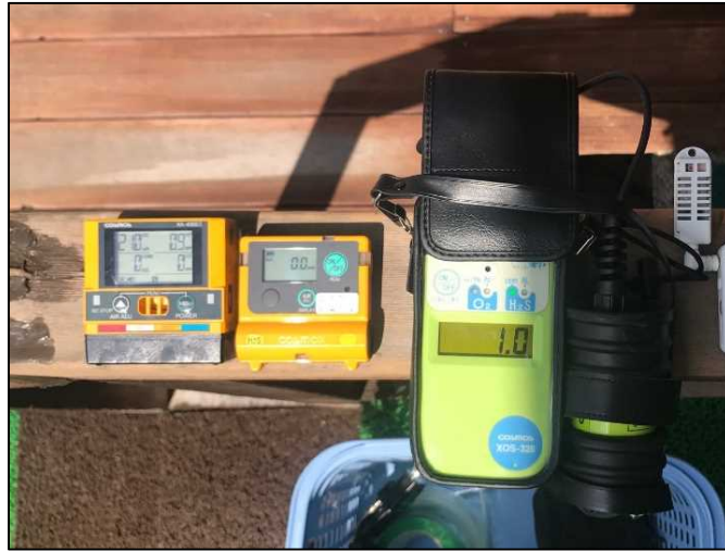
図 24 拡散式及び吸引式硫化水素計
