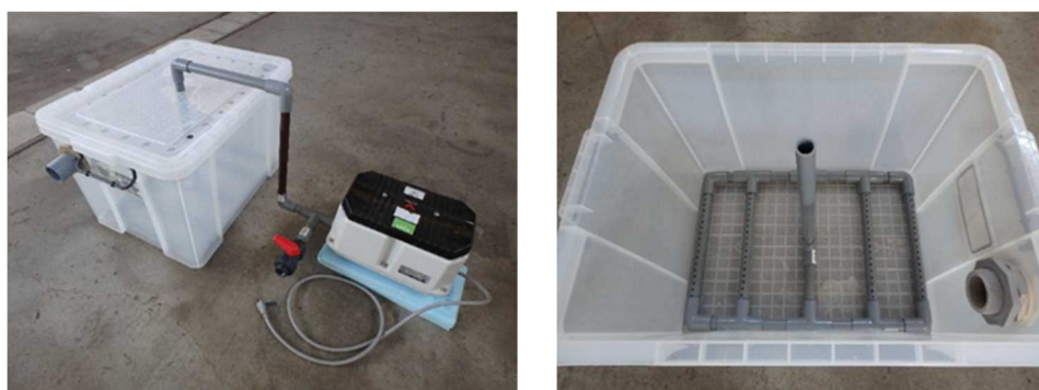
図 4 送気式ばっ気装置(実証試験器)
