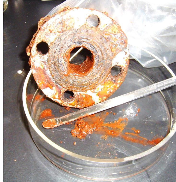
ポリエチレンライニング管のひび割れによる鉄さび
