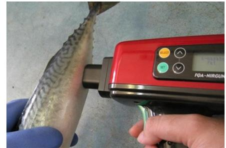
図 1 近赤外分光器によるマサバの脂肪量測定
