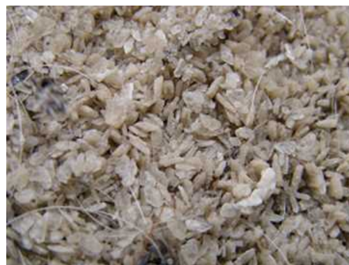
図 13 板状アルミパンチング材への付着状況と結晶化物
