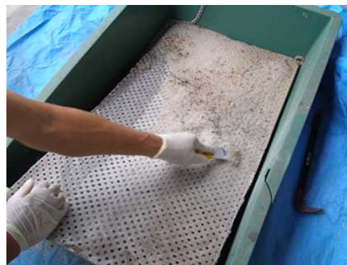
図 4 部材に付着した結晶化物の剥ぎ取り状況
