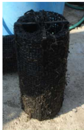
図 12 円筒状多層ステンレス網への付着状況
