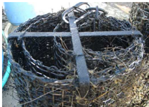
図 12 円筒状多層ステンレス網への付着状況
