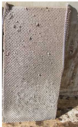
図 13 板状アルミパンチング材への付着状況と結晶化物
