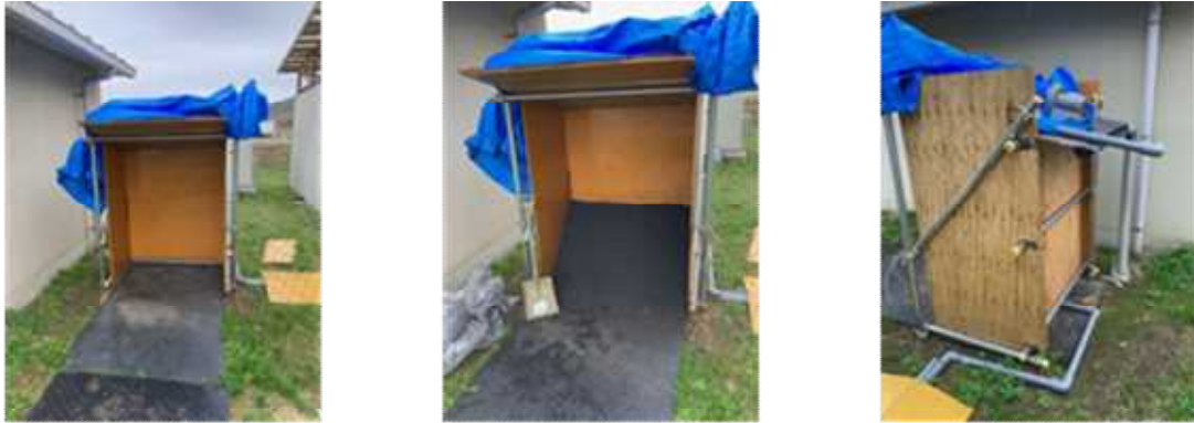
堆積型脱臭槽（資材充填前） 堆積型脱臭槽（資材充填後） 堆積型脱臭槽背面図
