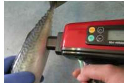
図 1 近赤外分光器によるマサバの脂肪測定
