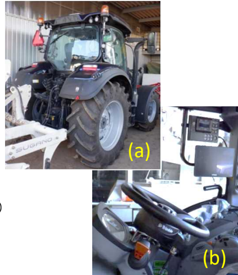
図1 自動操舵システム内蔵型トラクタ外観(a)と後付け型の内装パネルとハンドル部(b)
