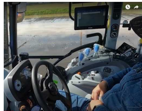
図2 自動操舵による代掻き作業
