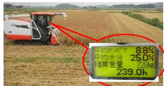
収量・食味コンバインの運転席にリアルタイムで表示される計測データ
