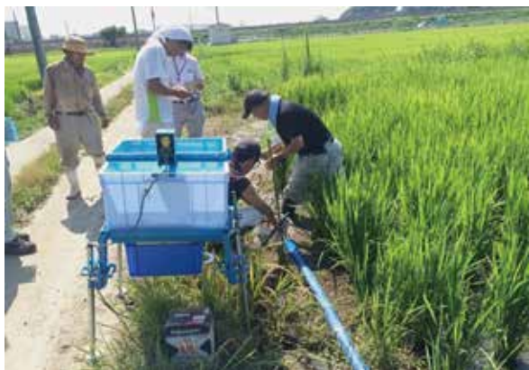
写真2 農研式流し込み施肥機による追肥作業
