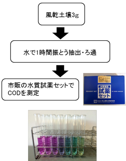
図1 可給態窒素簡易・迅速分析法の概略
