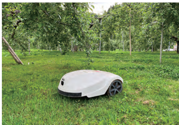
図2 りんご園で稼働するロボット草刈機
