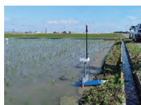
写真2 (右) 【農匠自動給水機】 設置したフロートが水位を感知して水管理を行う。
