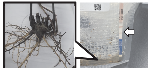
図2 センリョウ疫病の簡易診断 疫病が疑われる株の株元の一部をキットで検査すると、10分ほどで陽性が判別できる。（矢印は陽性反応のバンド）
