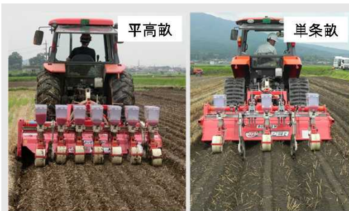
図4. 耕うん同時畝立て播種作業
