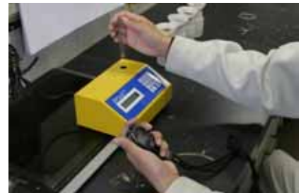
ふれんど7：抽出液の吸光度を測定し、標準温度20℃に変換して抽出窒素量を表示する装置
