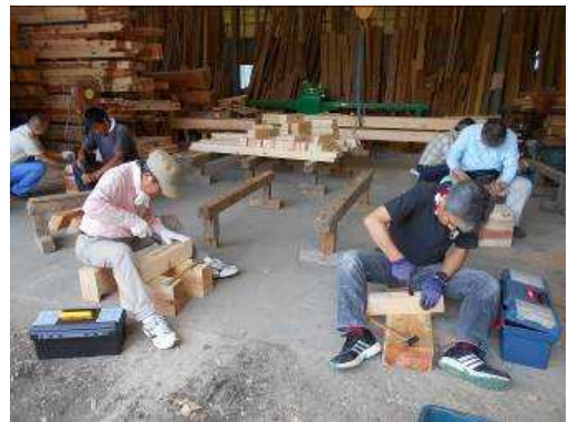
製作風景：ほぞ継ぎ部分をノミと金づちで加工
