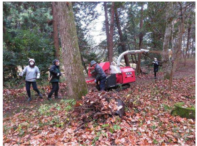
破砕機によりチップ化したものを園路に敷き均し
