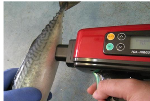
図 1 マサバ脂肪含量測定に用いた携帯型近赤外分光計
