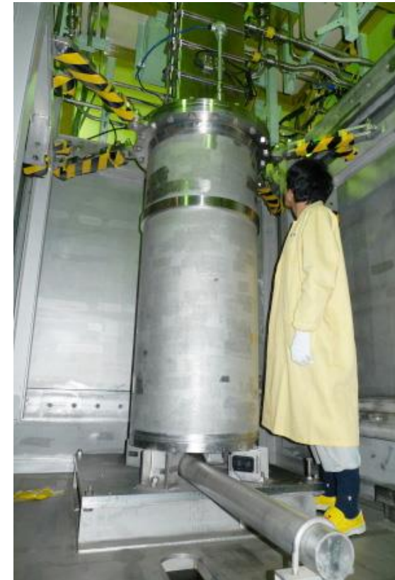
STACY炉心タンク (直径60cm、高さ1.5m)
