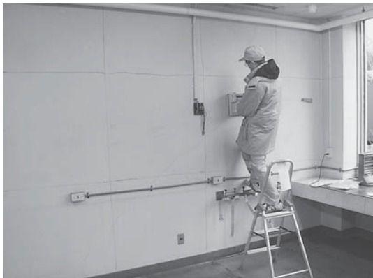
図7 汚染検査の様子(直接測定)
