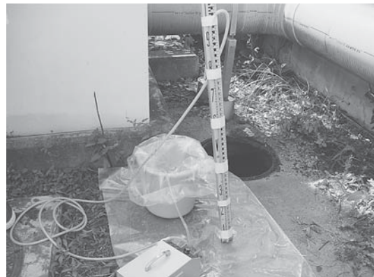
図8 貯留槽からの汚染検査試料の採取
