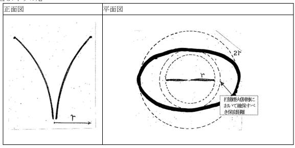
各煙火の保安距離を平面図の実線で示す。
