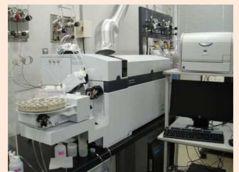
金属成分を分析する 誘導結合プラズマ質量分析計
