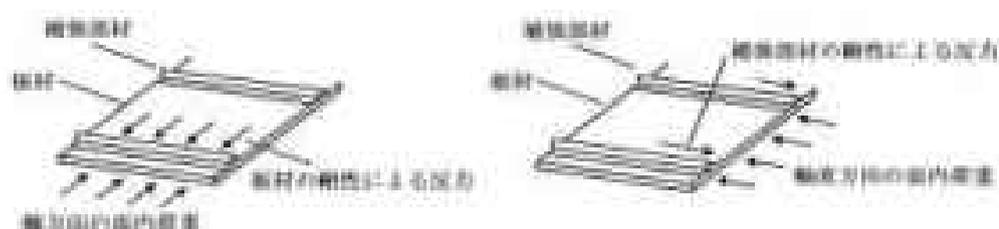
図 3.1.2-2 網板と補強部材による面内荷重
