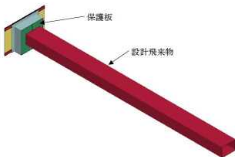
図 4.2-3 防護フードの解析モデル (全体)
