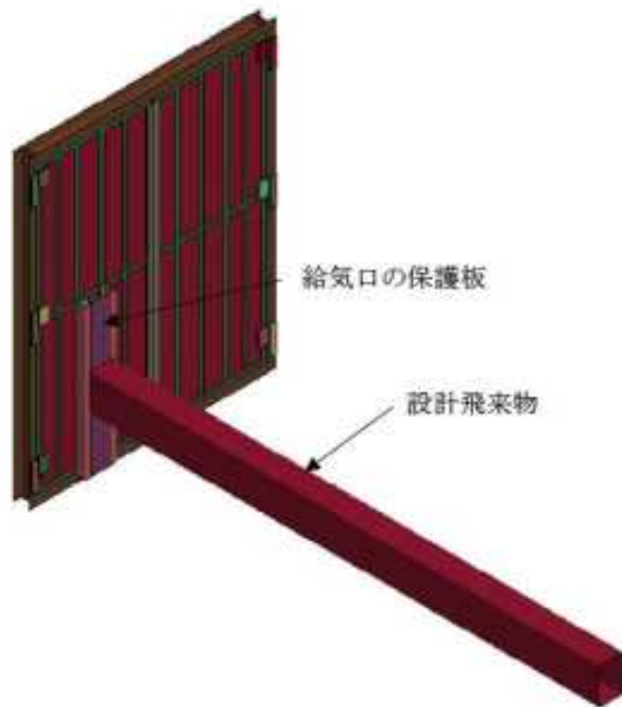
図 4.2-5 防護扉の解析モデル (全体)
