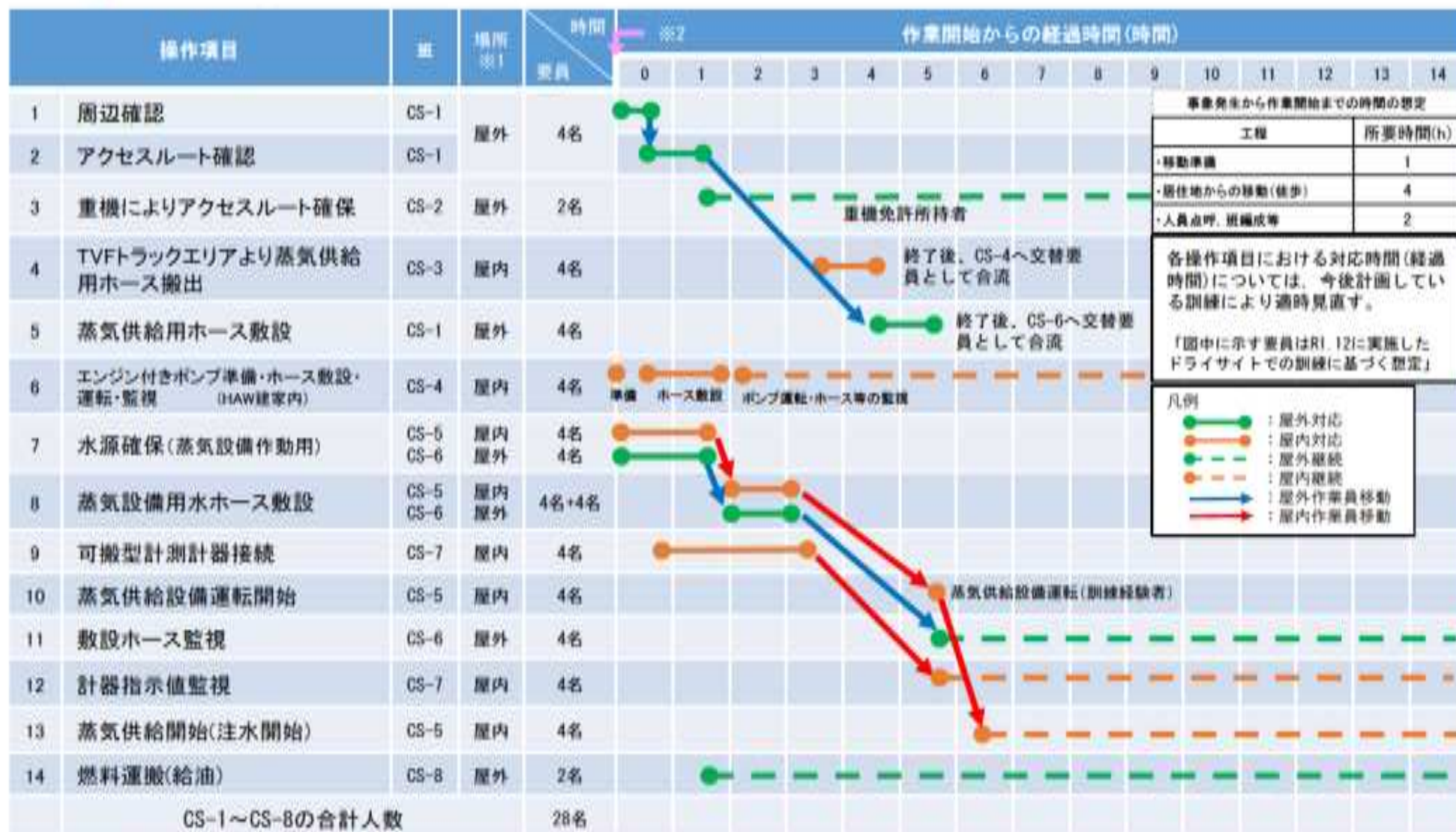
図1-7-6 [遅延対策] 貯槽への直接注水に必要な要員及び作業項目の例(ドライサイト)
