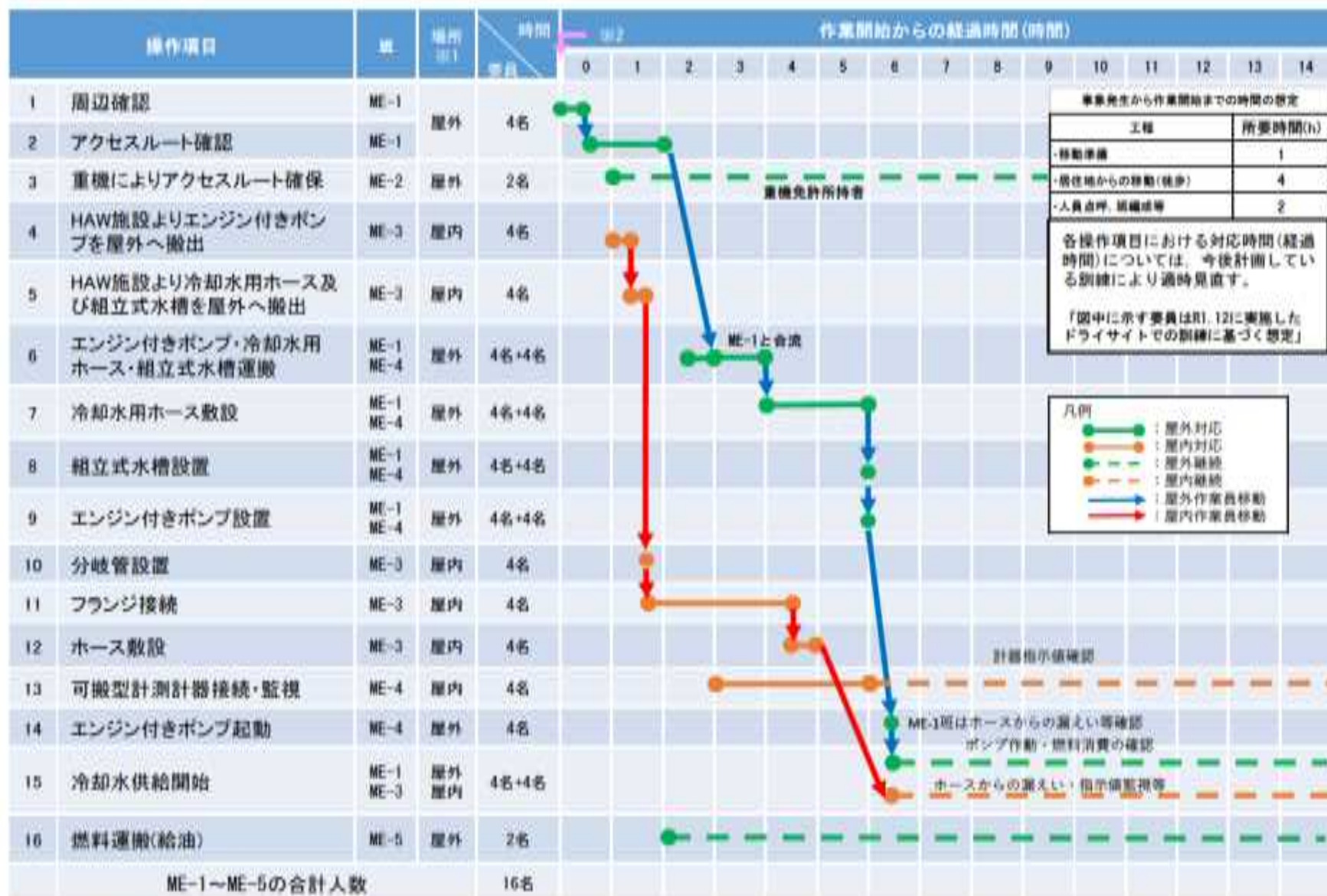
図 1-7-4 【未然防止対策】エンジン付きポンプによる冷却コイルへの通水に必要な要員及び作業項目の例（ドライサイト）
