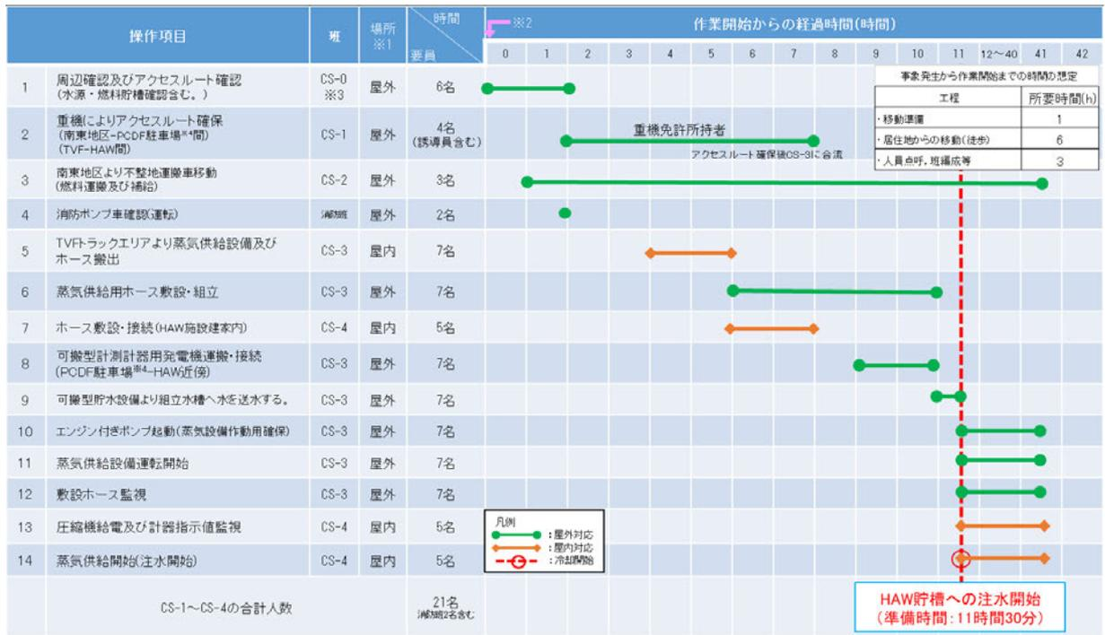
図 6 (2/2) HAW 遅延対策 ①：直接注水(可搬型蒸気供給設備使用)
