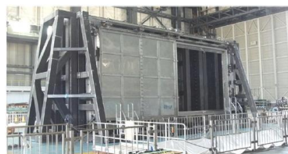
加振試験装置の例 (ブローアウトパネル閉止装置)
