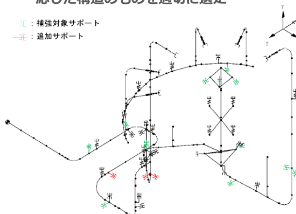
配管の耐震補強の例 (原子炉再循環系配管)
