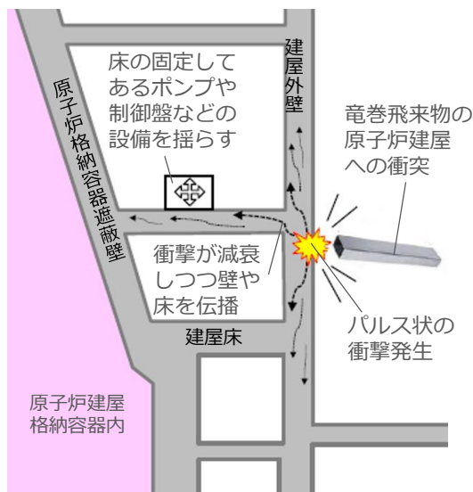
飛来物の衝突による衝撃の伝搬のイメージ
