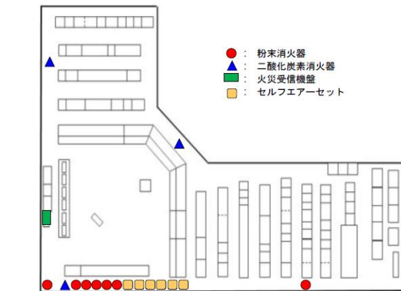
中央制御室内の消火器・防護具等の配備状況
