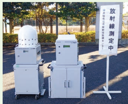
代替用の可搬型モニタリングポスト 測定設備が欠測した際の代替用測定器
