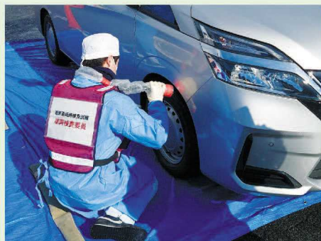
車両表面に放射性物質による汚染がないかを検査する様子
