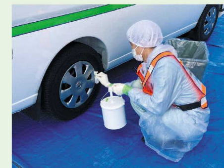
車両表面の汚染箇所をふき取り除染する様子
