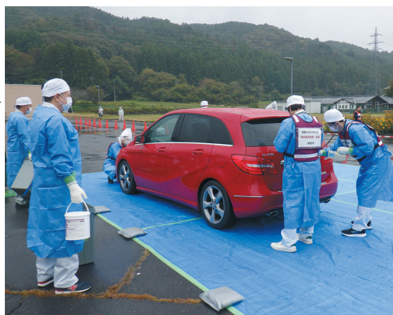
車両の汚染箇所を特定する検査
