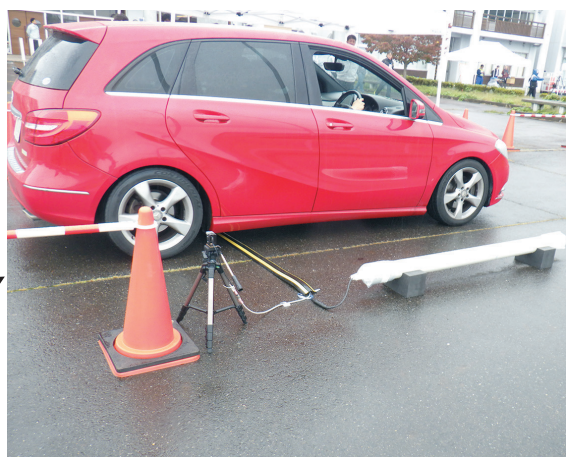
ゲート型モニタによる車両検査
