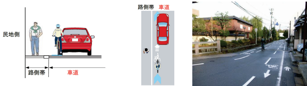
自転車、歩行者双方の通行空間をピクトグラムにより明確化
