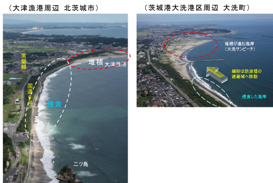
写真 2.8 大規模構造物周辺の堆砂と侵食
