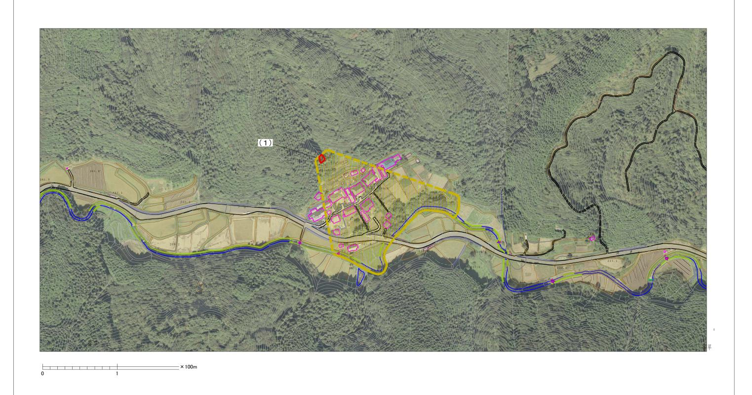
自然現象 の種類 様式-2(土) 土砂災害防止法施行令第二条の基準に該当する区域 土石流 渓流番号 214- I -001 土石流の高さが1m超える場合、土石等の 移動による力が50kN/㎡を超える区域 土砂災害警戒区域・土砂災害特別警戒区域 告示番号 茨城県告示第220号 渓流名 桃源沢 土石流の高さが1m超える場合、土石等の 移動による力が50kN/㎡を超えない区域 区域図(その1) 縮尺 1:2,500 告示年月日 平成22年3月8日 所在地 茨城県高萩市大字福平 その他の区域
