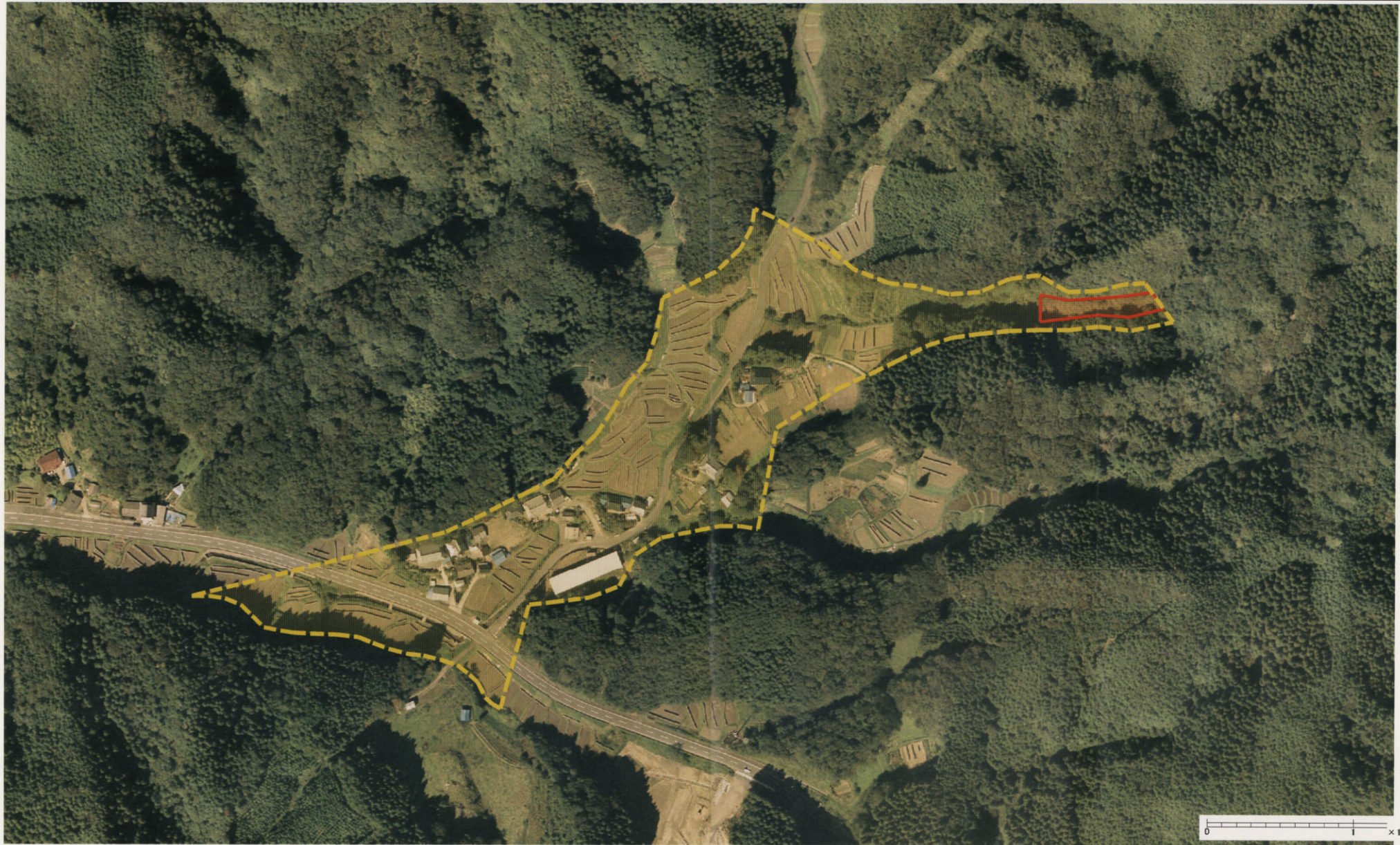
様式-3 (土) 土砂災害警戒区域・土砂災害特別警戒区域 区分図 (その3)
