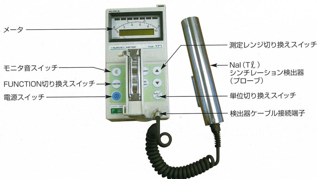
写真 2 NaI (Tl) シンチレーションサーベイメータ
