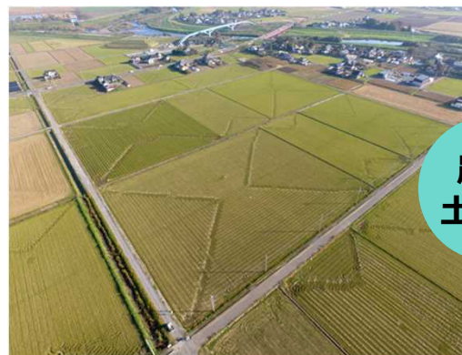
水田の大区画化・用排水路整備
