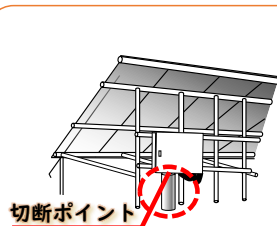
切断ポイント 集電盤根巻き
