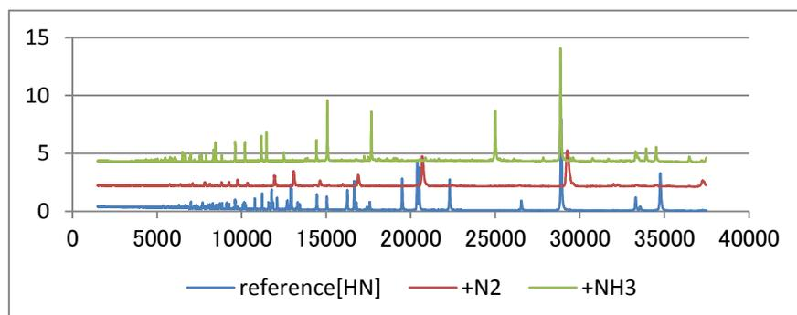
■ 結論: 「O」タイプ試料に対する N<sub>2</sub> の窒化処理のみが原料の構造変化を維持し、その他の反応性ガスすべてが原料と反応することがわかった。原料の構造を壊さない炭化 CVD 法が得られなかった。
