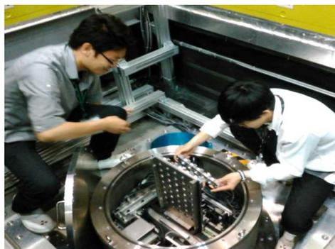
図1. iMATERIA 装置への試料取り付け作業
