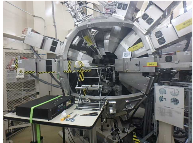
図 1 iBIX 回折計に LED 光源を設置
