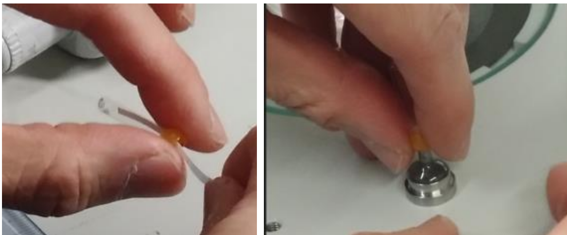
図3. 左:母液除去作業、右:風乾中の試料
