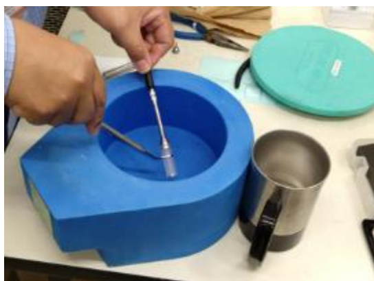
図15. 試料ピンカバーの外し作業
