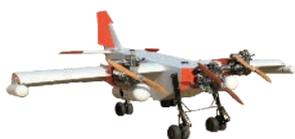
機体サイズ：全長3.4m，全幅2.8m，全高0.96m
