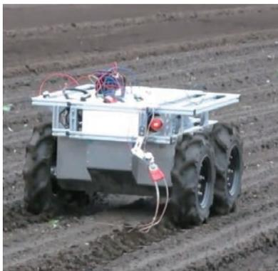
除草機を取付けた追従型運搬ロボット
