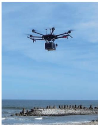
レーザーを搭載して飛行するドローン
